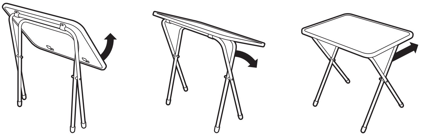
(рис. 3) Схема раскладывания стола (механизм «Познайка»)
