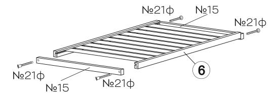
2. Установите ложе с планками №15 на уголки №23фи закрепите еврошурупами №24ф.
