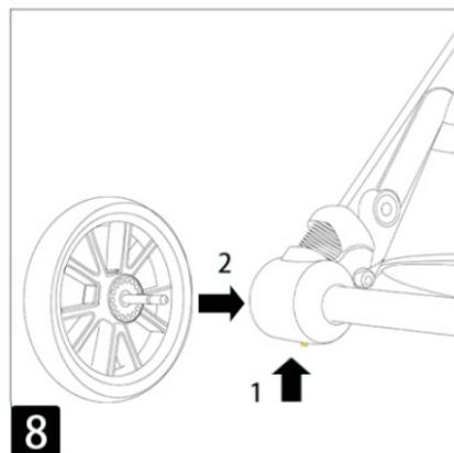
8. Как показано на рисунке, нажмите на кнопку 1 и потяните колесо, чтобы снять его.
