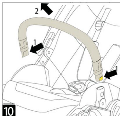
10. Как показано на рисунке нажмите две кнопки с двух сторон и потяните, чтобы снять бампер.
